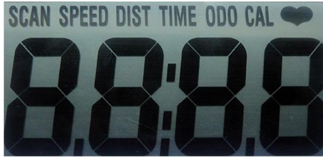
Şekil 4.15 Pasif matris LCD ekran
