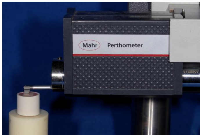
Şekil 2.15. Profilometre ile pürüzlülük ölçümü
