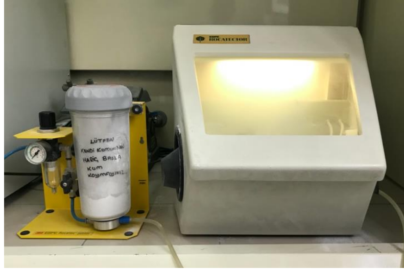
Şekil 2.12. Rocatec Junior kumlama cihazı
