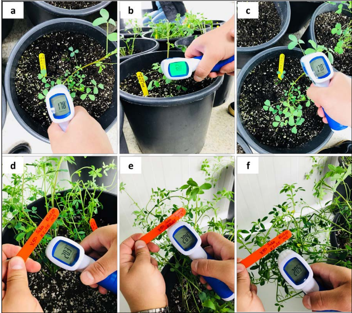
Şekil 14. Stres şartlarında yetiştirilen bitkilerin farklı zaman aralıklarında bitki kanopy sıcaklıklarının belirlenmesi a-b-c. Kuraklık stresinin 18. günü alt, orta ve üst kısımlardan bitki kanopy sıcaklıklarının belirlenmesine ilişkin görseller, d-e-f. Kuraklık stresinin 24. günü alt, orta ve üst kısımlardan bitki kanopy sıcaklıklarının belirlenmesine ilişkin görseller
