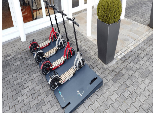
Şekil 1.2. Elektrikli scooter üzerinde kablosuz şarj çalışması [2].
