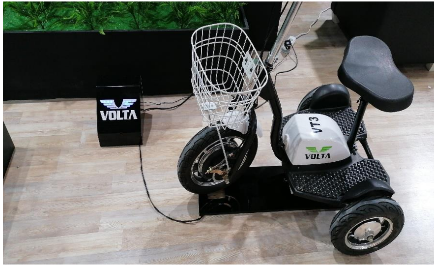
Şekil 1.3. Volta VT3 modeli kablosuz şarj çalışması.
