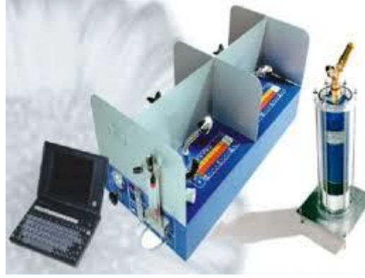
Şekil 2.10 Olfaktometre cihazı (URL-5, 2020)
