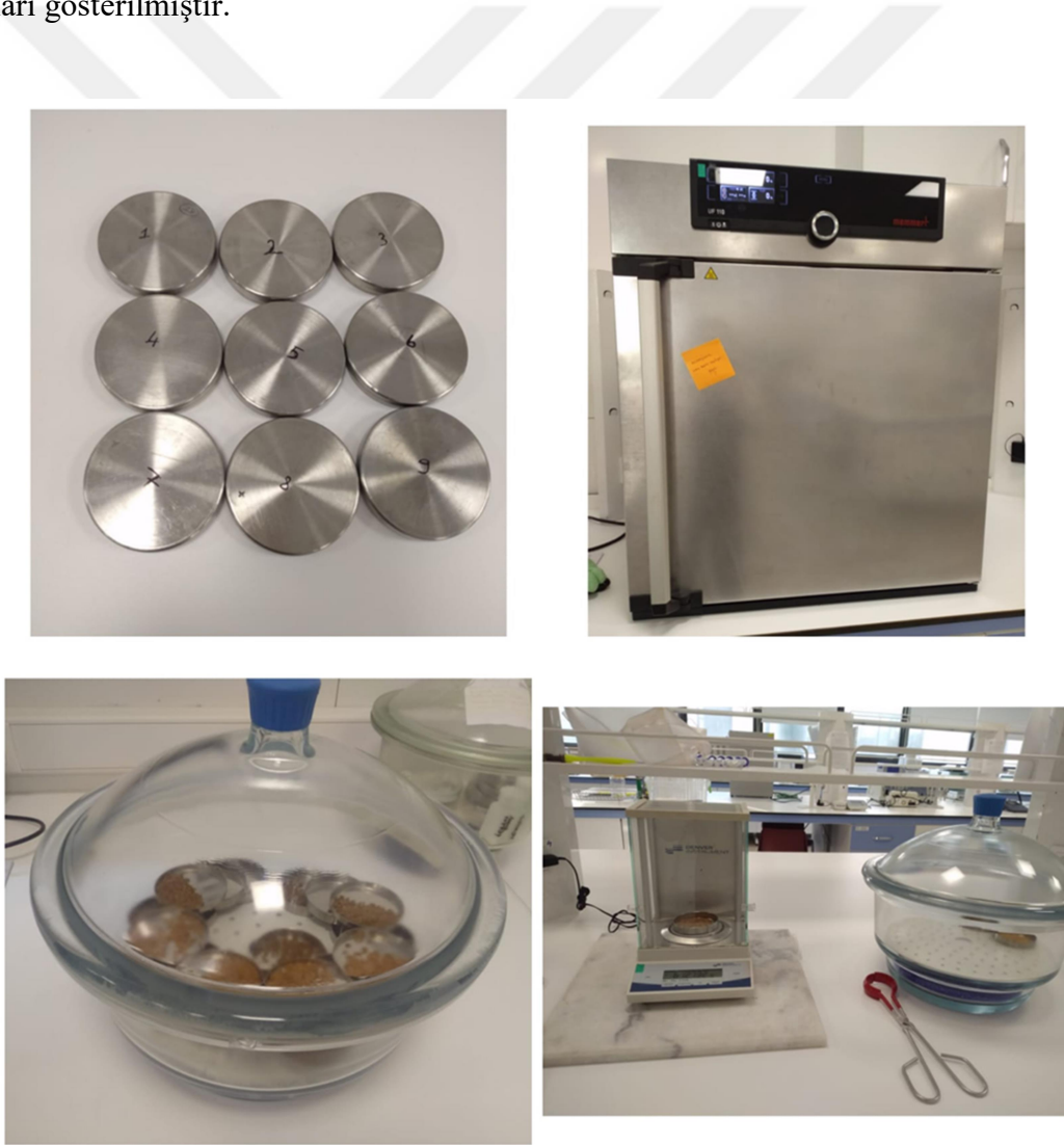
Şekil 10. Nem analiz aşamaları
