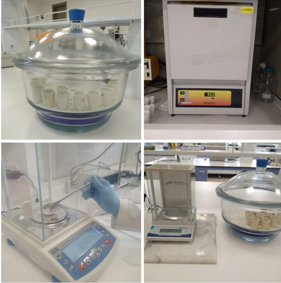
Şekil 11. Kül analizi aşamaları
