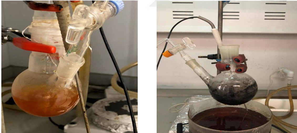
Şekil 2.2. Fe 3 O 4 nanoboyutlu parçacıkların sentezlenmesi.
