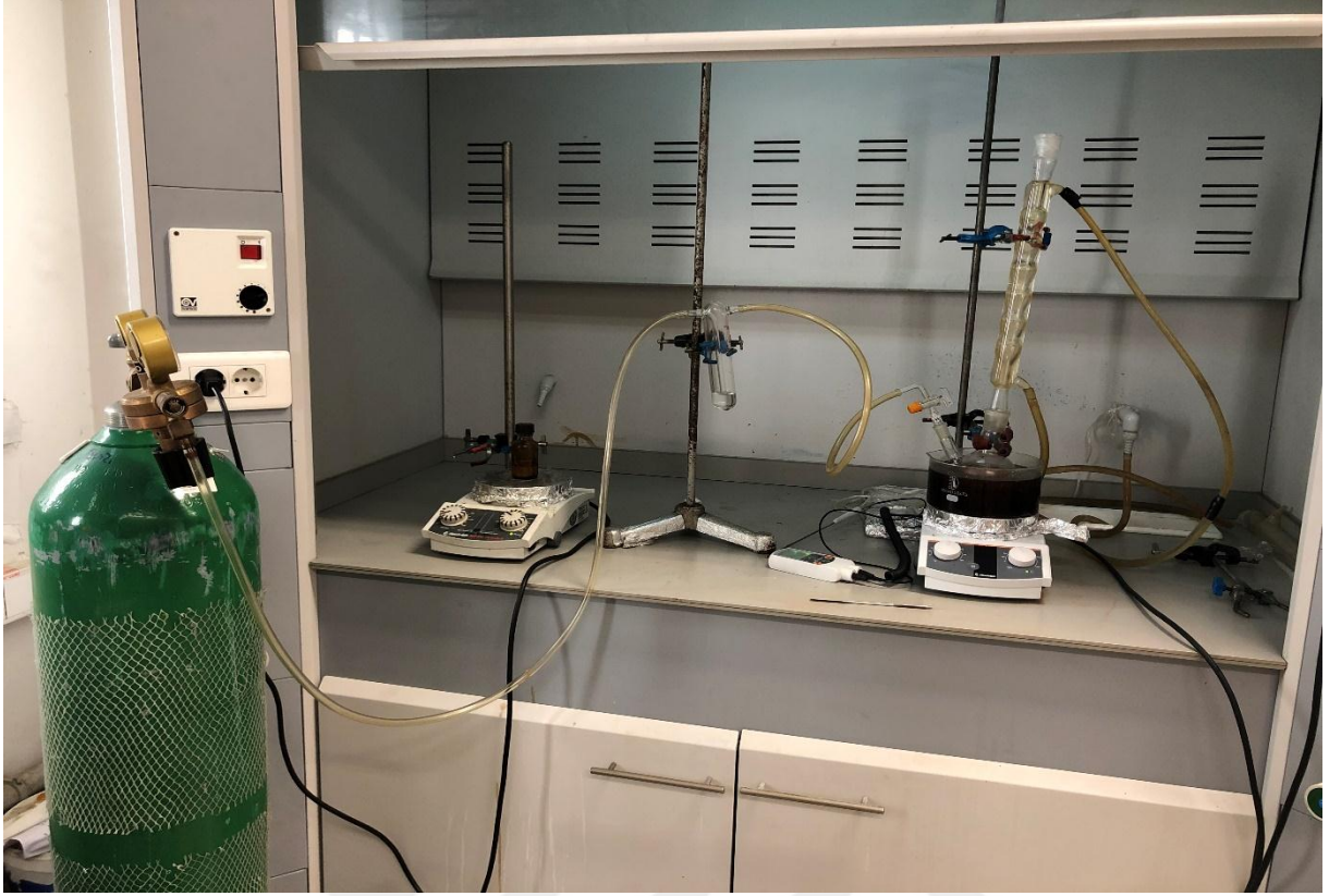
Şekil 2.1. N 2 gazı ortamında geri soğutucu sistem
