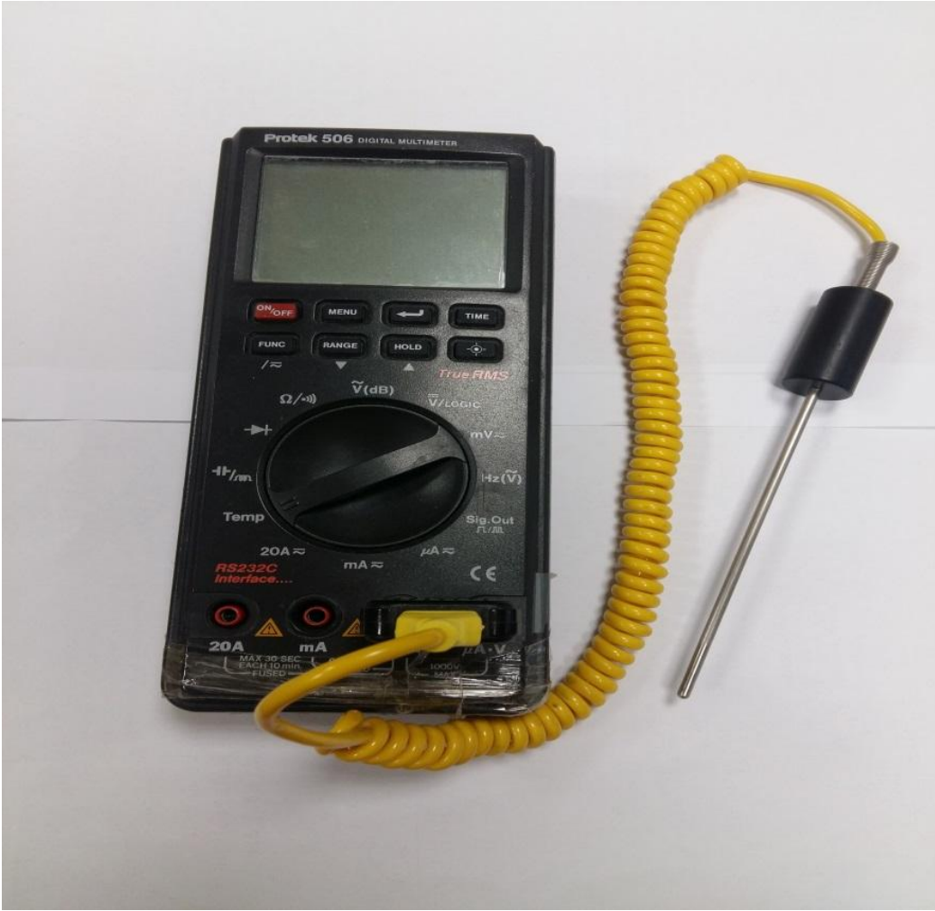
Ek 4. Örneklerin merkez sıcaklığını kontrol etmek için kullanılan termocouple
