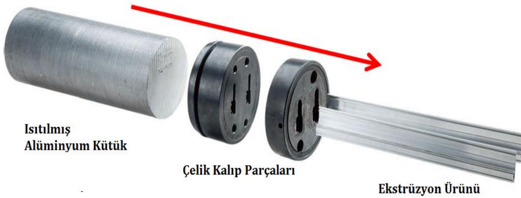
Şekil 3.1. Ekstrüzyon İşlem Şeması [45].
