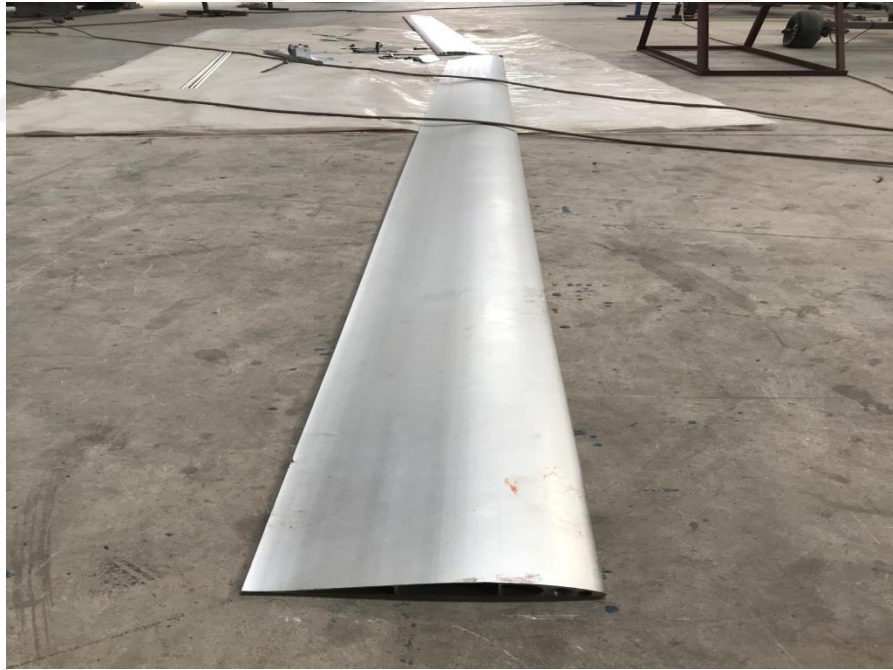
Şekil 3.17. Su soğutmadan çıkan aerofil yapı.
