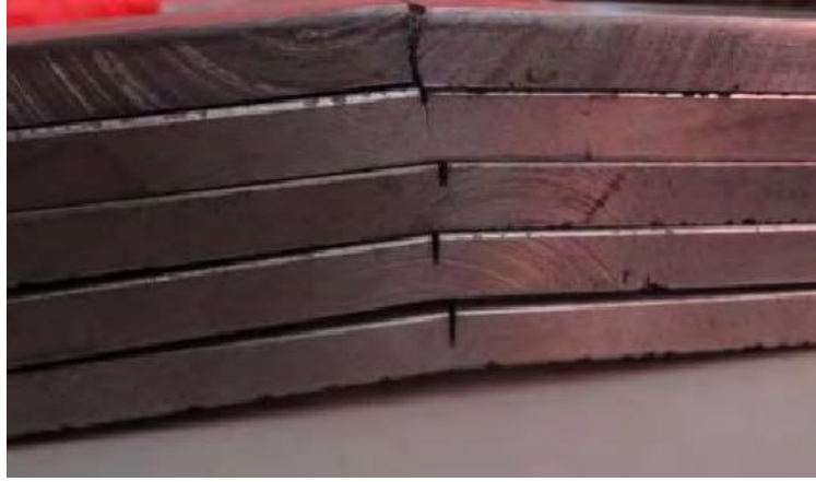
Şekil 3.41. Deney esnasında çatlak oluşumu.
