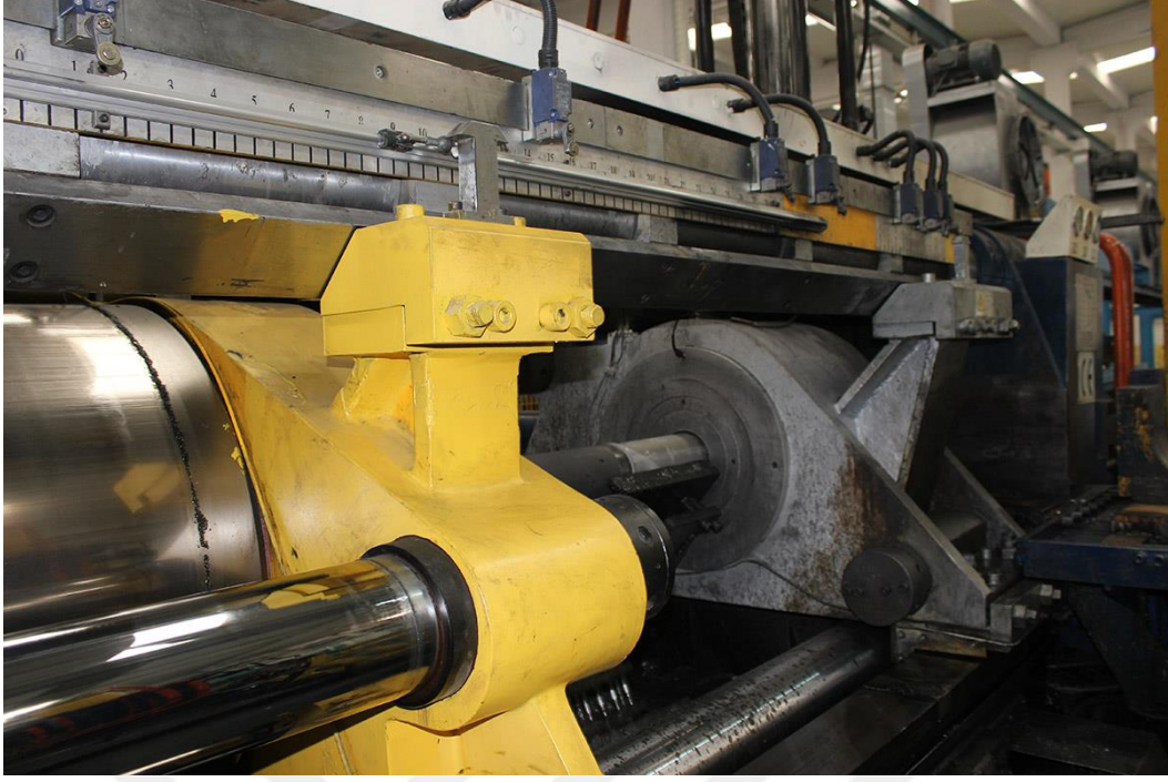
Şekil 3.12. Alüminyum biyete ekstrüzyon yapılması.
