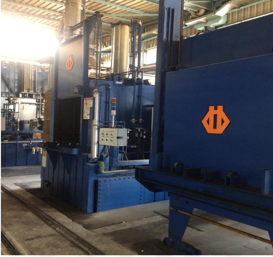
Şekil 3.20. Isıl İşlem Fırını.
