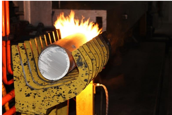
Şekil 3.7. Biyet ısıtma fırını.
