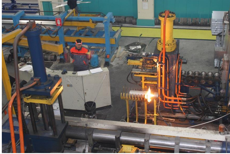
Şekil 3.8. Alüminyum biyet ısıtılması.
