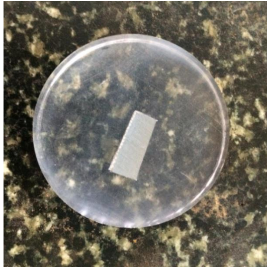
Şekil 3.47. Sertlik ölçümü için çıkartılmış numune.
