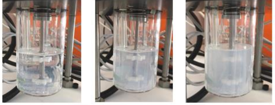
Şekil 4.11 FBNP reaktör sistemi ile asidik ortamda sentezlenen titanyum nanopartikül inkübasyon görüntüsü
