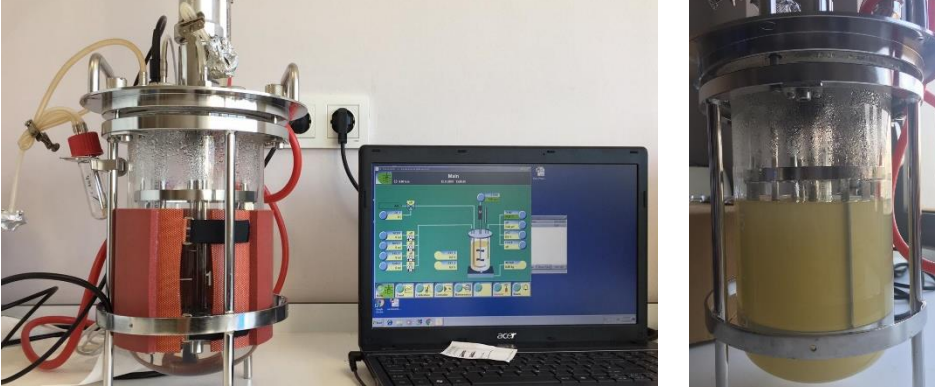
Şekil 3.4 Galdieria sulphuraria 'nın karıştırırmalı reaktörde kültivasyonu
