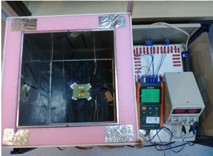
Resim 3.12. Elektronik kart kompleksinin kabin içerisindeki yerleşimi
