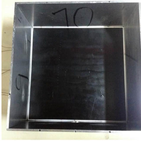
Resim 3.7. Mat siyaha boyanmış bakır plakanın kabin içerisindeki yerleşimi
