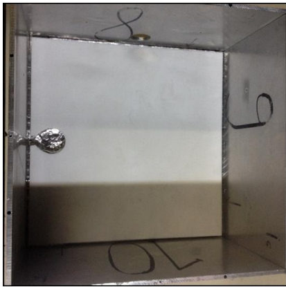
Resim 3.5. Teflon yalıtımın kabin içerisindeki yerleşimi
