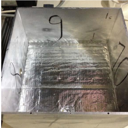
Resim 3.4. Folyo kaplı cam yününün kabin içerisindeki yerleşimi
