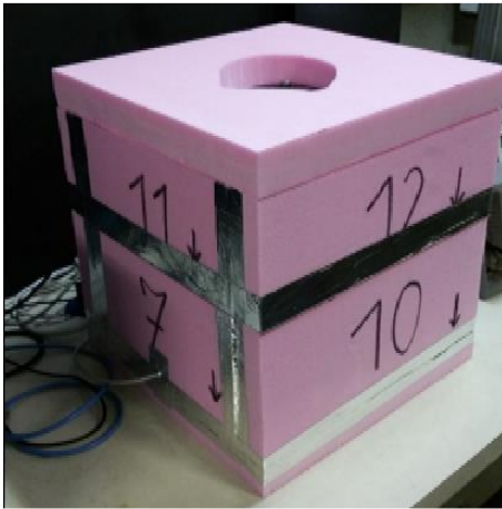
Resim 3.8. Kabin dış yalıtımı
