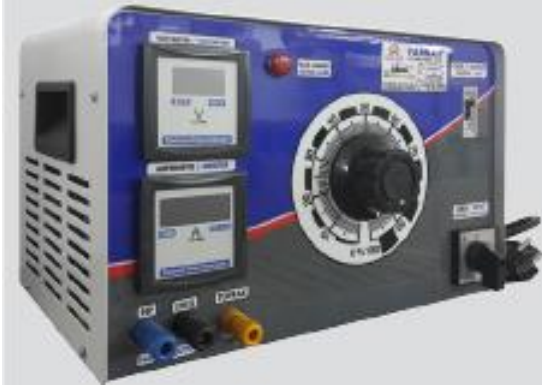
Resim 3.9. Rezistanslı ısıtıcıya kontrollü güç verilmesi için kullanılan varyak
