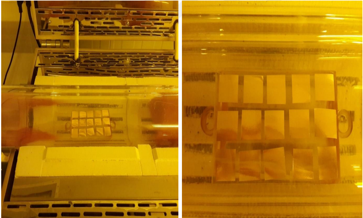
Şekil 21. Bakır folyoların CVD grafen sistemine yüklenmesi
