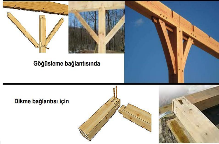
Şekil 5.6. : Göğüsleme ve dikme bağlantılarında ahşap yapılarda uygulanan lamba-zıvana birleşim örnekleri [2].
