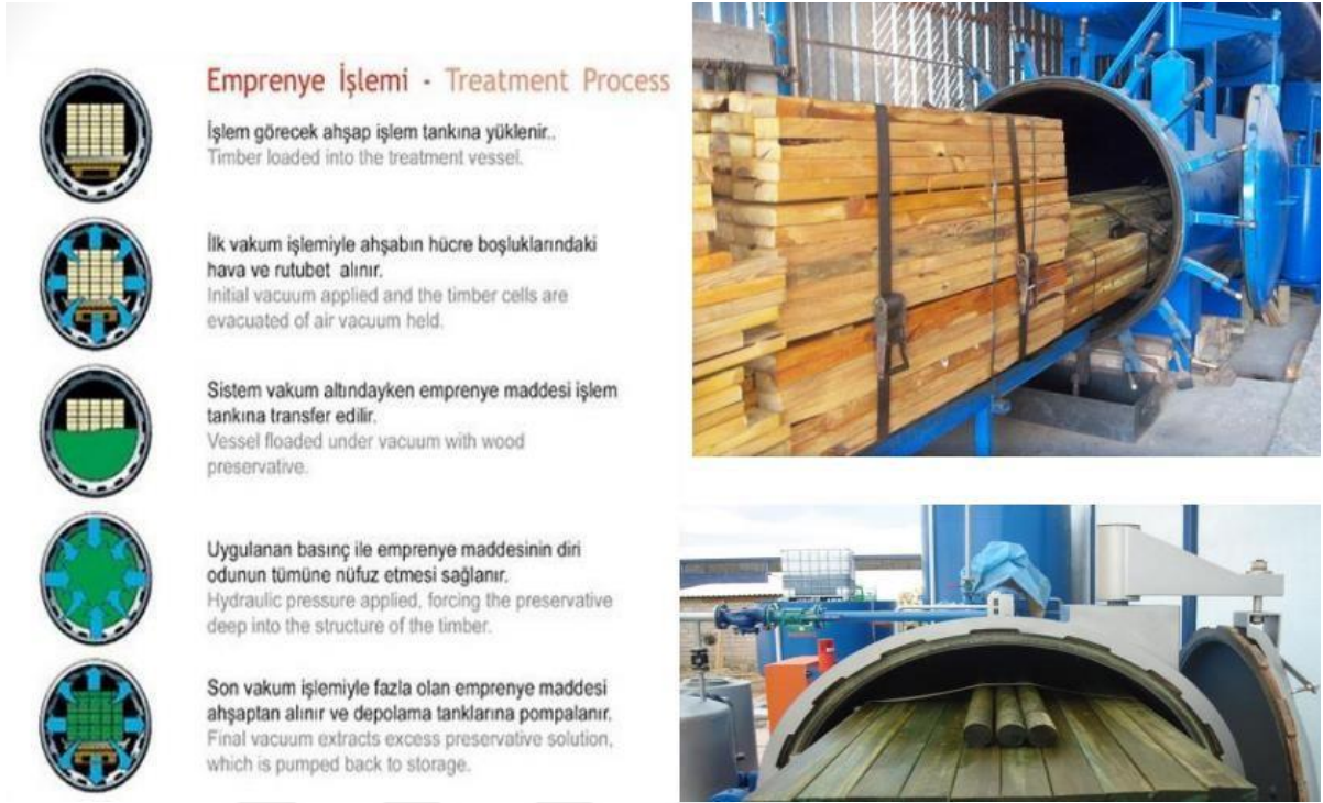
Şekil 3.7. : Basınç uygulanarak emprenye işlemi aşamaları [12].
