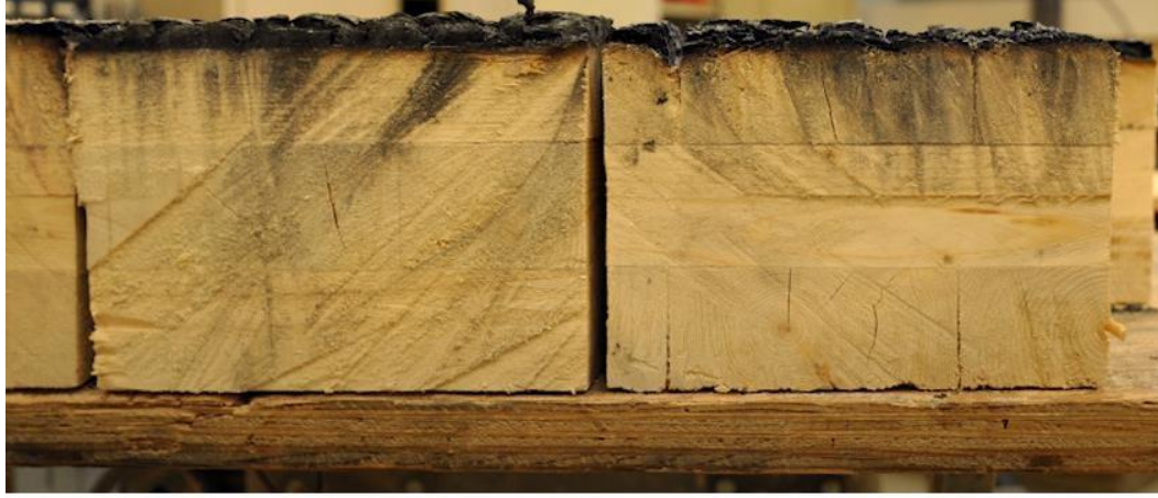
Şekil 10.2. : Laminasyon tekniğiyle üretilmiş (CLT) ahşap malzemenin deney sırasından sonraki görüntüsü [99].
