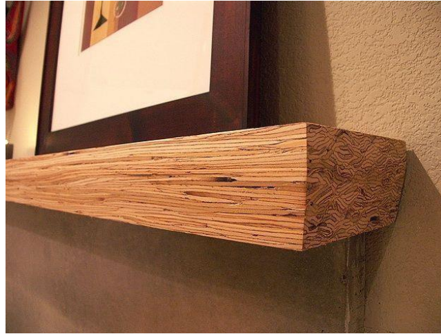
Şekil 4.12. : LVL-MİCROLAM uygulaması örneği [34].
