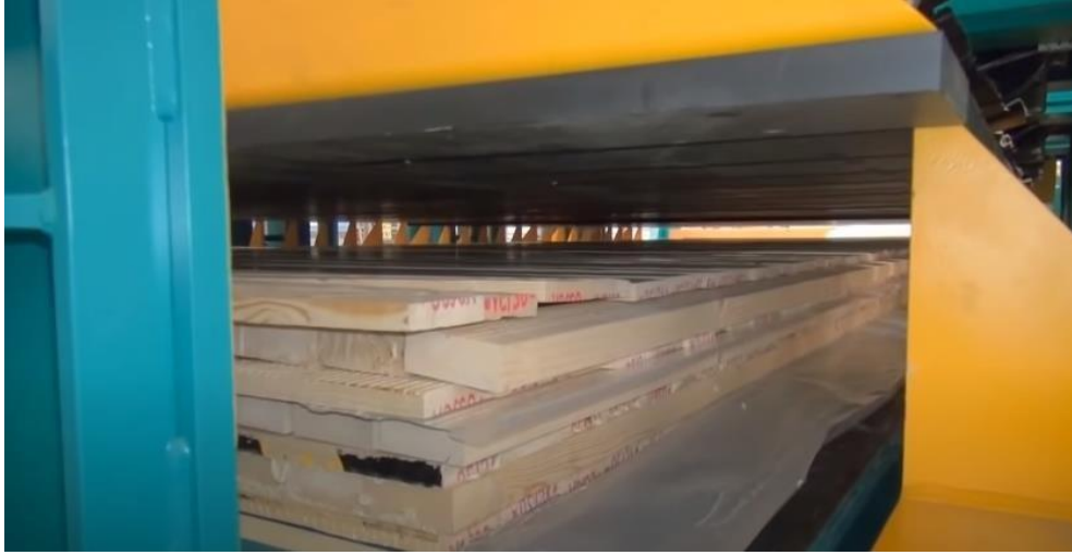
Şekil 4.10. : Ahşap malzemenin pressleme işleminden sonraki görünümü [30].
