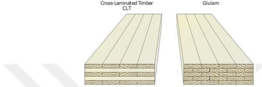
Şekil 4.11. : CLT ve GLULAM uygulaması farklılıkları [32].
