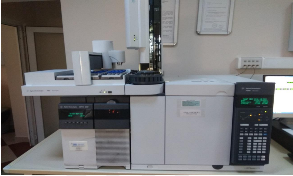
Resim 3.3. Analiz esnasında gaz kromatografi/kütle spektroskopisi cihazı ve numunelerin konulduğu kısım
