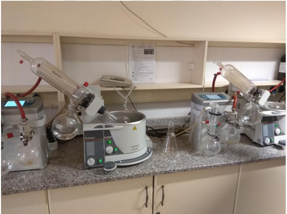
Resim 3.5. Su Örneklerinin Evaporatör ile Uçurulması
