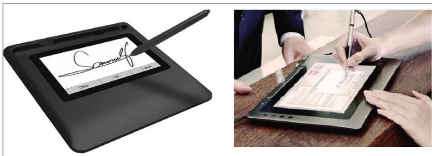
Şekil 3.2. Çevrimiçi imza örneği ve imza cihazı
