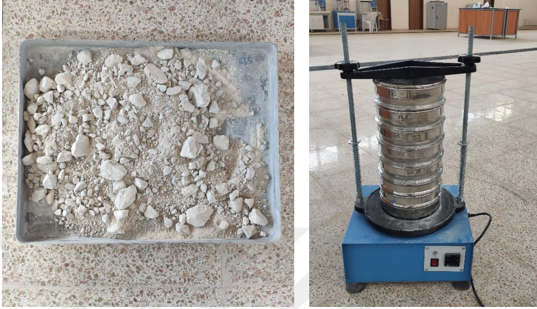
Şekil 3.3. Elek analizi deneyi
