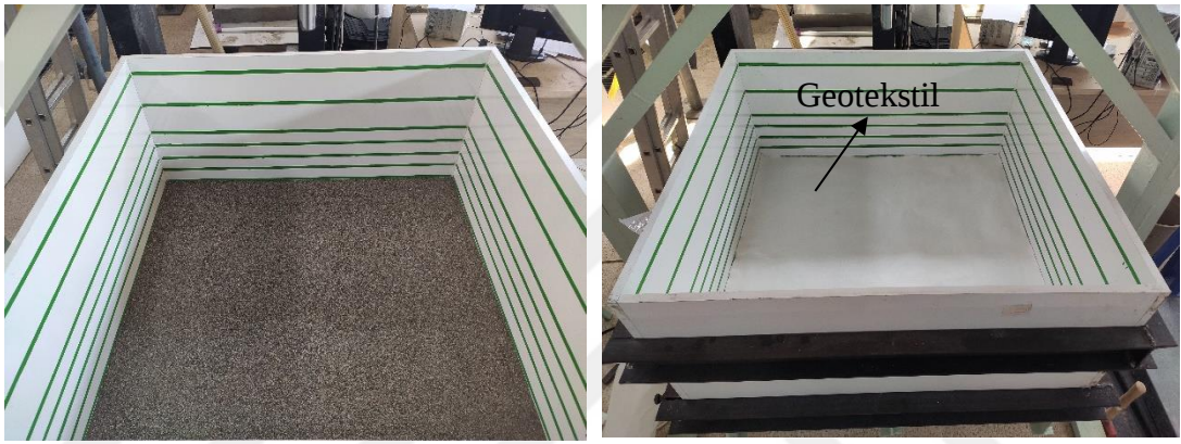
Şekil 3.10. Kum zeminin yerleştirilmesi ve geotekstilin örtülmesi
