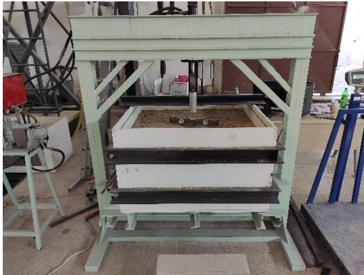
Şekil 3.11. 300 mm temel tabakasına sahip geocell ile güçlendirilmiş deney
