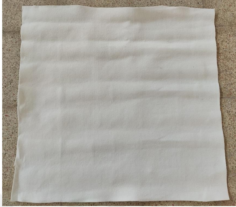
Şekil 3.16. Deneylerde kullanılan geotekstil malzemesi
