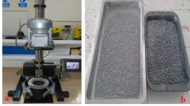
Şekil 3. 18 (a) Karıştırmalı bilyeli değirmen, (b) çelik bilyeler.
