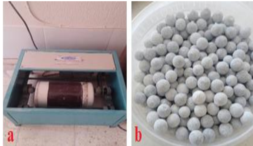
Şekil 3. 17 (a) Seramik değirmen haznesi, (b) seramik bilyeler.
