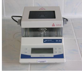
Şekil 3. 12 Denver IR-30 nem tayin cihazı.
