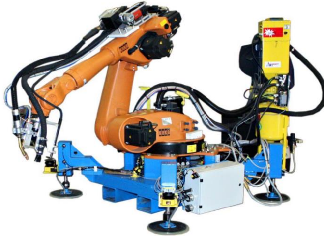
Şekil 1.3. Robot kol ile toz altı kaynak otomasyonu
