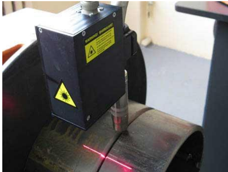
Şekil 3.15. Lazer sensör ile kaynak iz takibi
