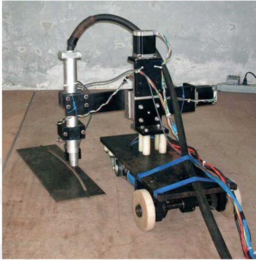
Şekil 3.9. Lazer sensör ile mobil kaynak traktörü kullanımı [5].
