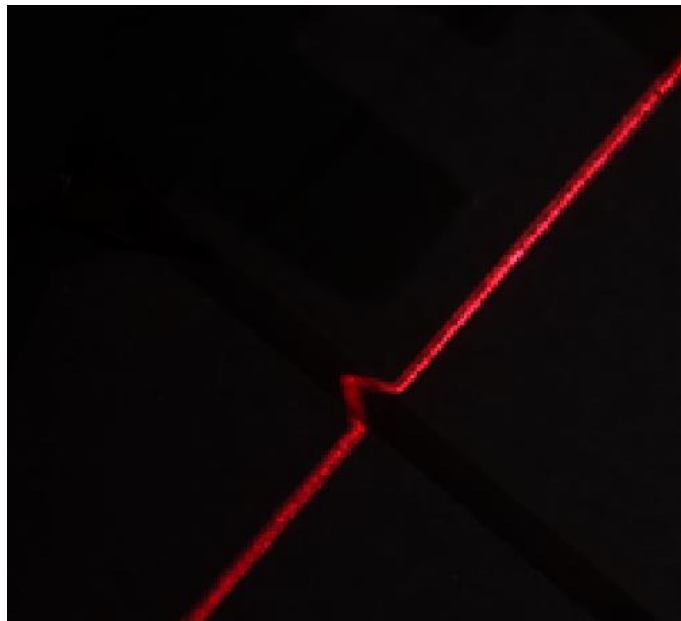
Şekil 3.23. Kamera önüne bandpass filtre takılarak elde edilen kamera görüntüsü
