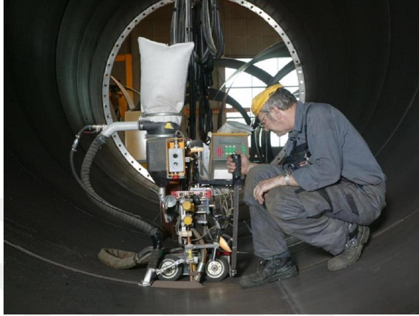
Şekil 1.2. Basınçlı tank imalatında toz altı kaynak traktörü kullanımı.
