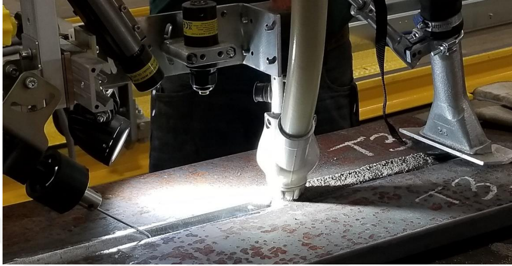
Şekil 3.14. Lazer sensör ile mobil kaynak traktörü kullanımı [37]
