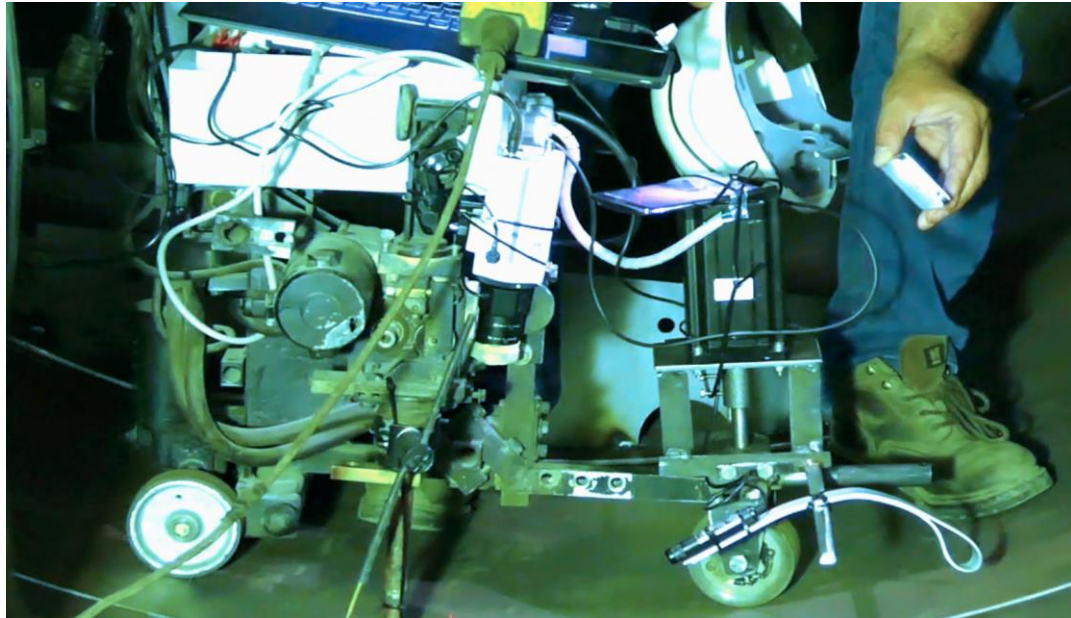
Şekil 4.3. Traktörün ilk kalibrasyonunu yapıp ortalayarak yerleştirme.
