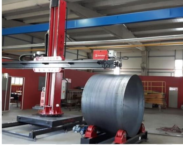
Şekil 1.4. Column and boom sistem ile toz altı kaynak traktörü
