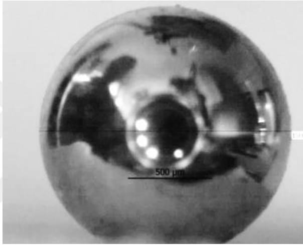
Şekil 3.18 Sistemde kullanılan 1500 \mu\text{m} çapında paslanmaz çelik bilye
