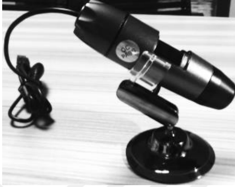
Şekil 3.8 Geliştirilen sistemde kullanılan sayısal mikroskop
