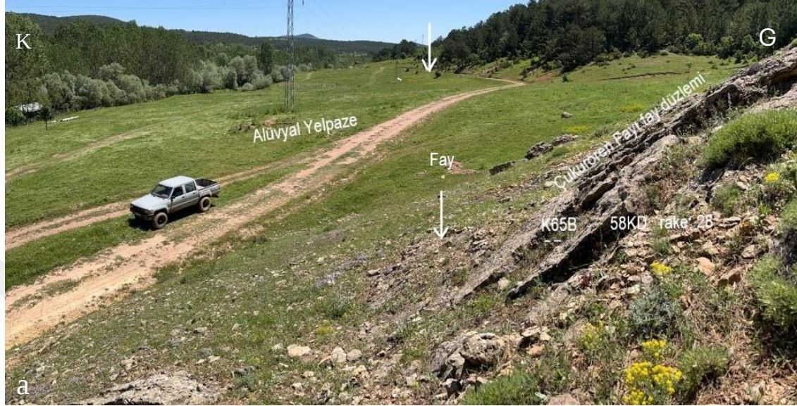
Görsel 4.13: a) Oysu Köyü Yüylük Köprüsü Sol Kenarı 4 Nolu İstasyon, Çukuroren Fayı Doğu Segmenti'ne Ait Fay Düzlemi ve Alüvyal Yelpaze Görüntüleri, b) Fay Düzlemi Üzerinde Fay Çizikleri, c) Fay Düzlemi Üzerinde Kinematik Ölçüm d) Kayma Yüzeyi Kinematik Ölçümlerine Göre Yapılan Paleostres Diyagramı
