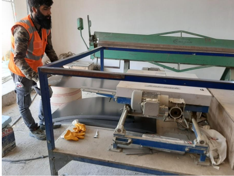
Şekil 6.7 : Rulo malzemeden kesilen levhaların kenetlerinin oluşturulması amacıyla araç yardımıyla şekillendirilmesi.
