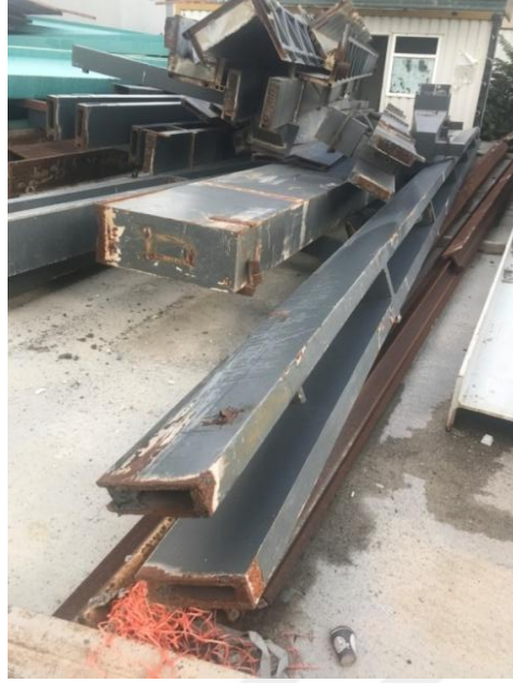
Şekil 3.4 : Saçaktan sökülen ve daha sonra galeriyi kapatan döşeme yapımında kullanılan çelik kirişler.
