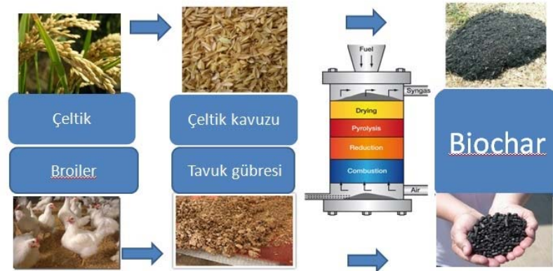
Şekil 3.1. Denemede kullanılan biyokömür kaynağı ve piroliz işlemi sonrası elde edilen ürün
