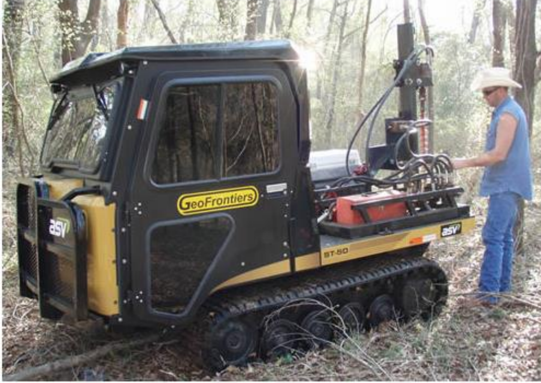
Şekil 1.1. Amerikan Geofrontiers arama şirketinin toprak gazı toplama amaçlı sonda aracı (Geofrontiers, 1993)
