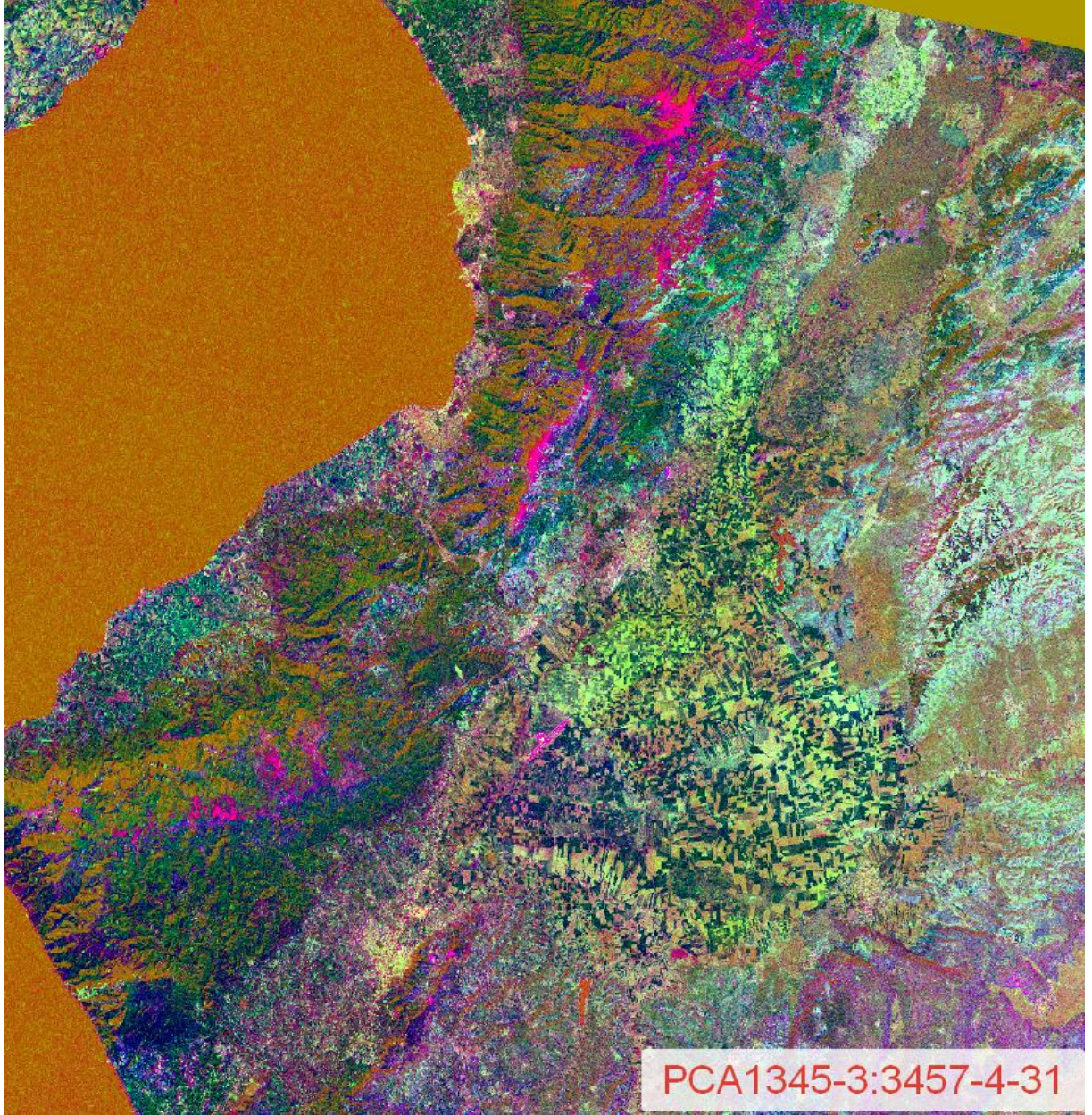
Şekil 3.24. Landsat-7 ETM+ PCA R: 1345-3, G: 3457-4, B: 3/1 bant oranı kompozit görüntüsü
