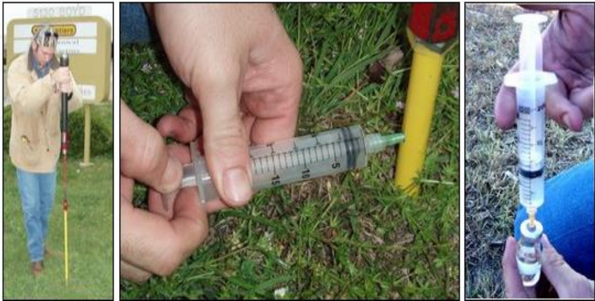
Şekil 1.2. Amerikan Geofrontiers arama şirketinin toprak gazı toplama amaçlı sonda aparatı (Geofrontiers, 1993)
