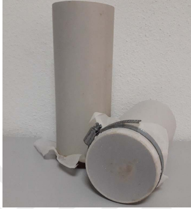
Şekil 2.3: 38 - 40 \mu\text{m} gözenek aralığı olan ipek bezlerden yapılmış süzgeçler
