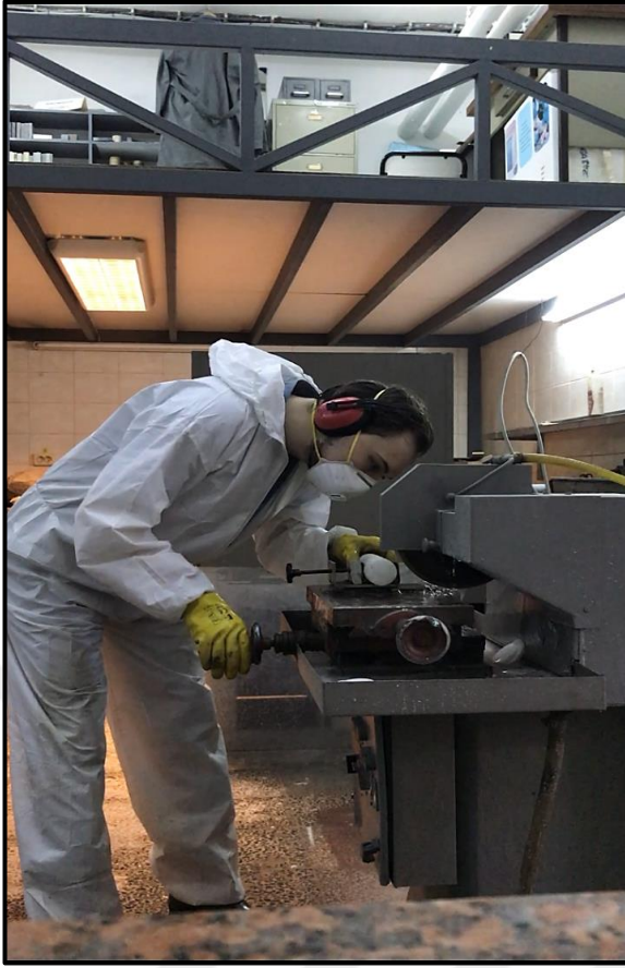
Şekil 5.3 : İTÜ Jeoloji Mühendisliği örnek alma laboratuvarında yapılan karot düzeltme işlemi.
