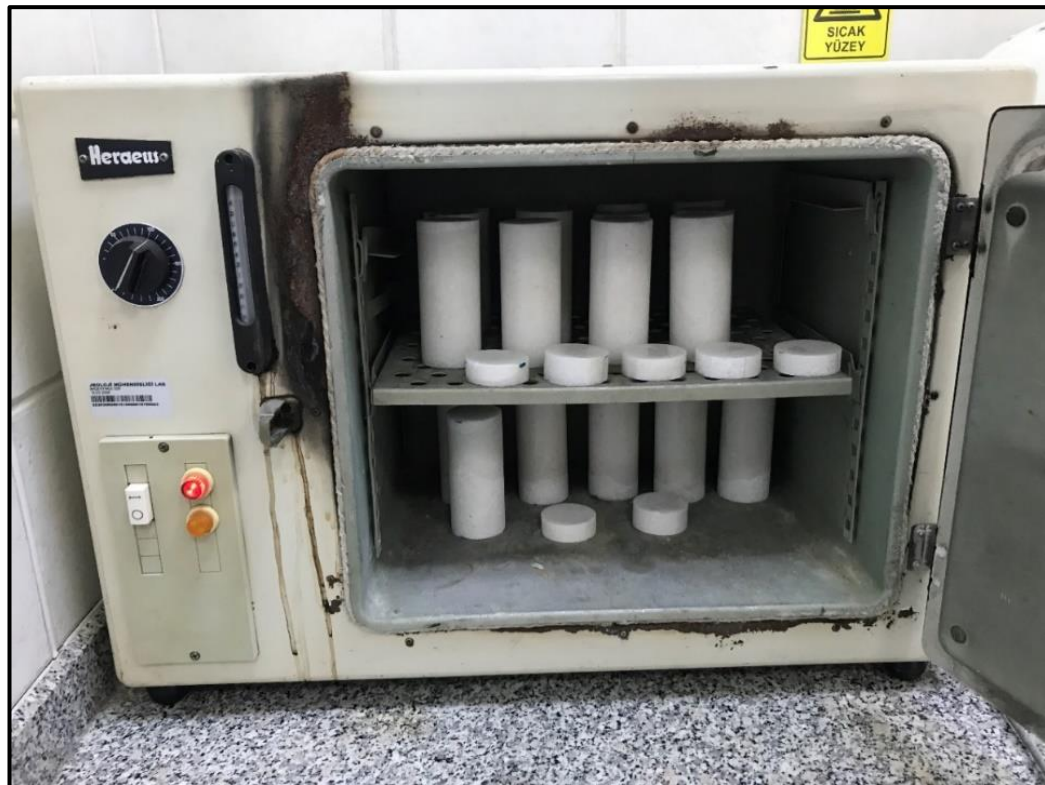
Şekil 5.7 : Muğla-Kavaklıdere mermer örneklerinin 105 0 C'lik etüvde kurutulması.
