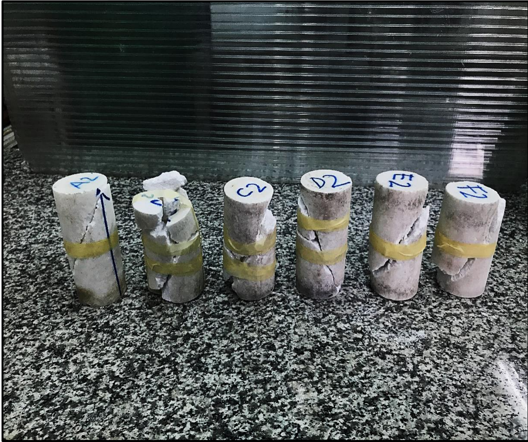
Şekil 5.27 : 1. ve 2. grup örneklerin üç eksenli deney sonrası yenilme formları.
