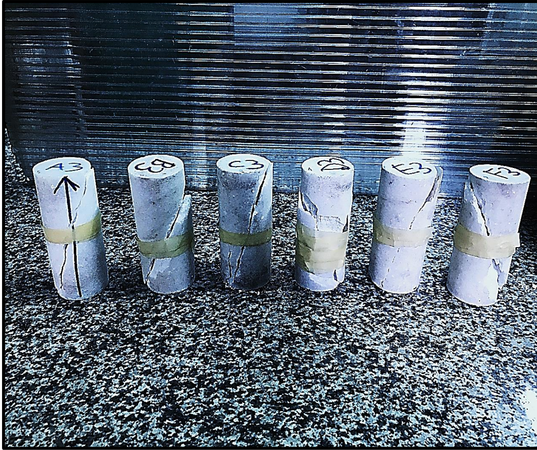
Şekil 5.31 : Tek eksenli basınç deneyi sonrası örneklerin görünüşleri.
