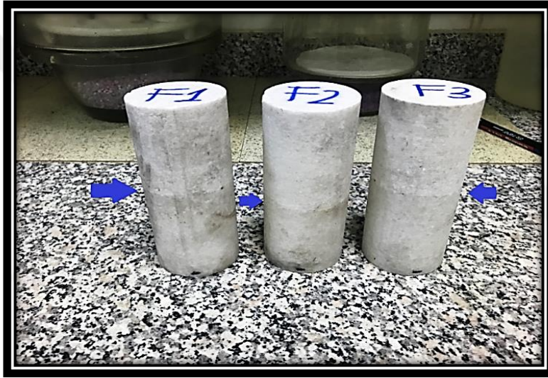
Şekil 2.7 : Kayaç örneğinin zamana bağlı olarak kapiler su emme seviyesi (Muğla-Kavaklıdere mermer örneği).
