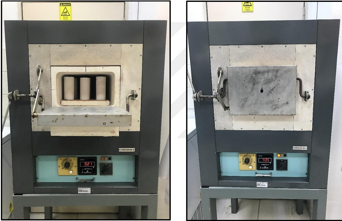
Şekil 5.14 : Isıtım işlemde kullanılan yüksek sıcaklık fırını (etüv).
