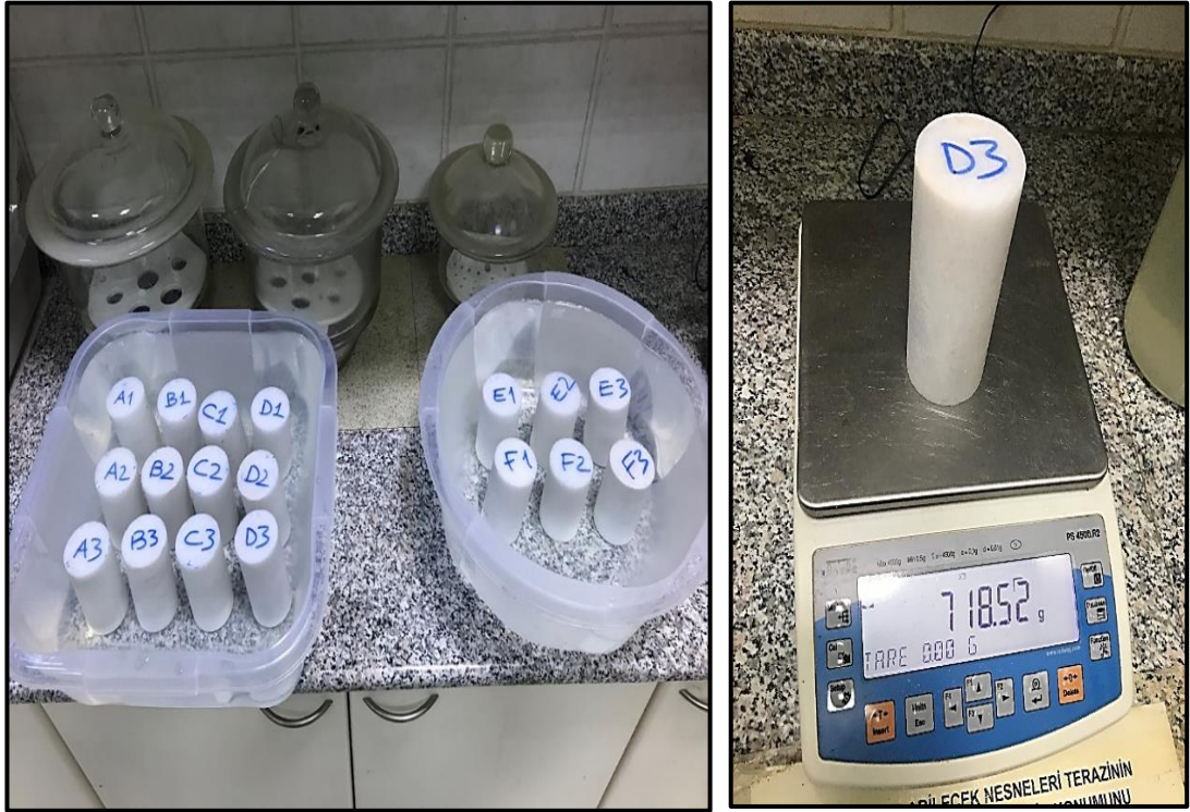
Şekil 5.8 : Deney örneklerinin suya doymunluklarının sağlanması ve doymun ağırlığının hassas terazide tartırması.
