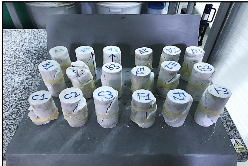
Şekil 5.26 : Üç eksenli deney sonrası örneklerin yenilme görüntüleri.
