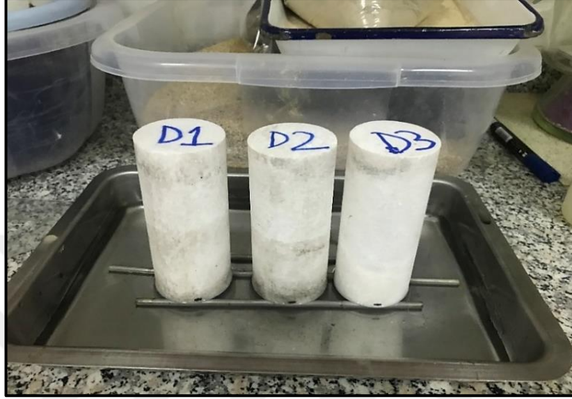
Şekil 5.15 : D grubu mermer örneklerinin kapiler su emme deneyine tabi tutuluşu.
