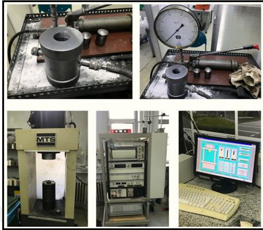
Şekil 5.28 : Üç eksenli deneyde kullanılan yükleme ve kayıt sistemi.
