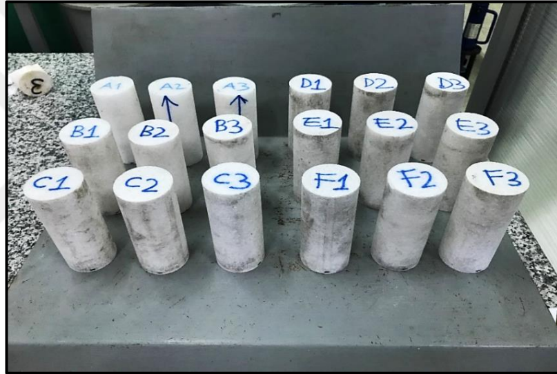
Şekil 5.25 : Üç eksenli deney öncesi örneklerin görüntüleri.
