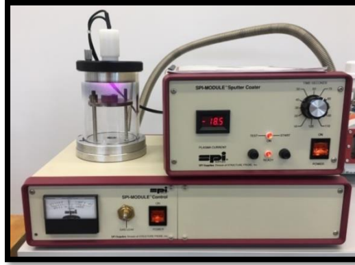
Resim 14. Örneklerin altın film tabakası ile kaplanması
