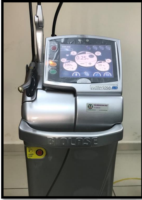
Resim 9 ve 10. Er, Cr:YSGG lazer (Waterlase, Biolase , San Clemente, USA) ve kullanılan parametreler
