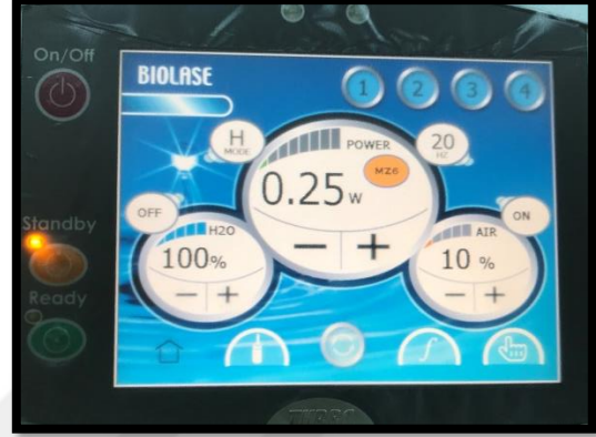
Resim 9 ve 10. Er, Cr:YSGG lazer (Waterlase, Biolase , San Clemente, USA) ve kullanılan parametreler
