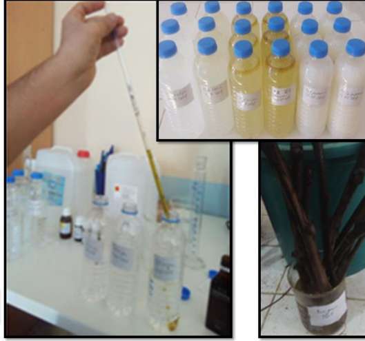
Şekil 3.5. Esansiyel yağ çözeltisi hazırlanışı ve uygulanışı.
