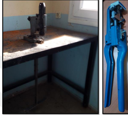
Şekil 3.2. Masabaşı pedallı omega aşısı makinesi ve yongalı göz aşısı el makinesi.
