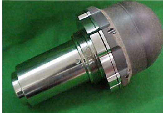
Şekil 3.4 Yüksek Çözünürlüklü Radar Yaklaşım Sensörü
