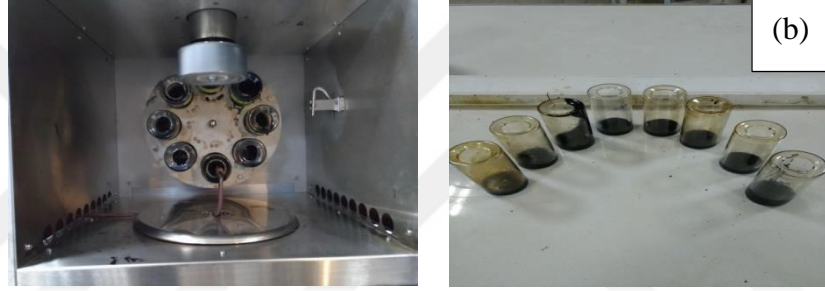
Şekil 3.15. RTFOT deney aleti iç görünüş (a), RTFOT deney aleti deney tüpleri (b).
