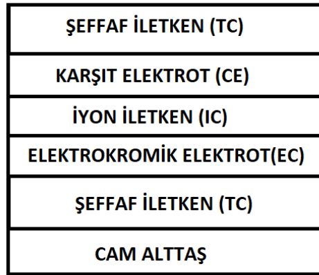
Şekil 2.1. 5 farklı katmandan oluşan bir ECD'nin şematik diyagramı [25].
