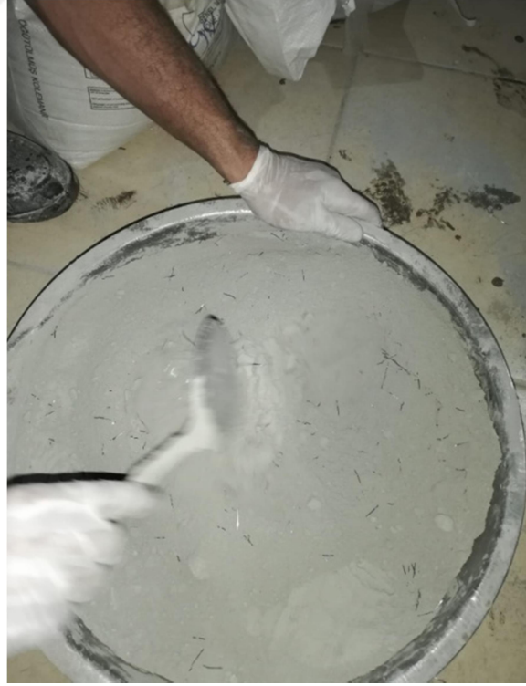
Şekil Ek 1.6. Çelif Eklenmiş Malzeme Karışımı
