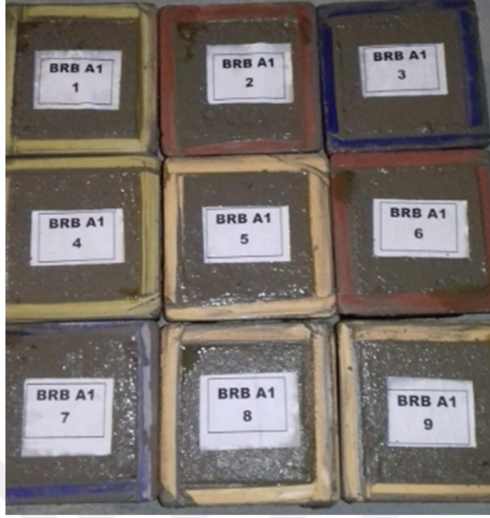
Şekil 2.17. Kalıplara konulmuş bor agregalı lifsiz referans beton numuneleri
