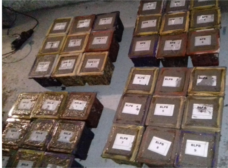
Şekil 2.16. Kalıplara konulmuş bor agregalı beton numuneler
