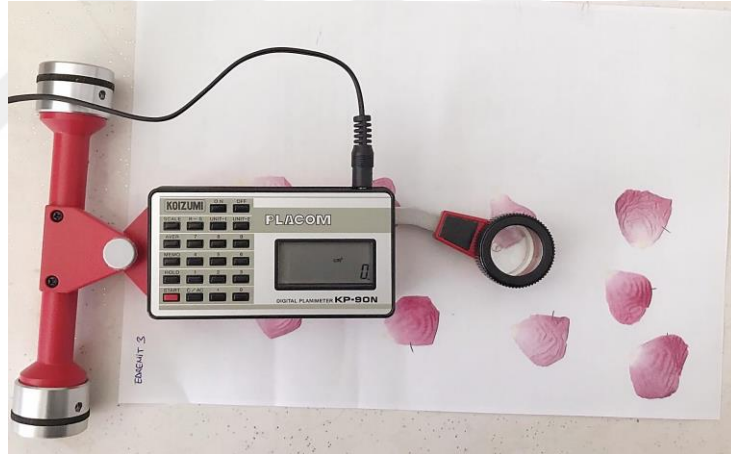
Şekil 3.2. Planimetre ile taç yaprakların alan ölçümü.
