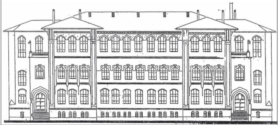
Şekil 3.39 Konya Darülmüallimini ön cephe rölövesi (Anonim, 2010).
