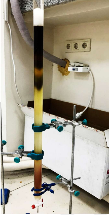
Resim 3.3. S. multicaulis kök DKM-aseton (1:1) ekstresine ait kolon kromatografisi
