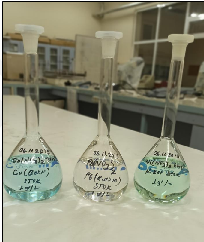
Şekil 4.3: Kurşun, nikel ve bakır tekli ağır metal stok çözeltileri.
