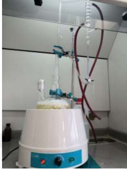
Şekil 4.3 Clevenger düzeneği ile sarımsak uçucu yağlarının elde edilmesi işlemi.
