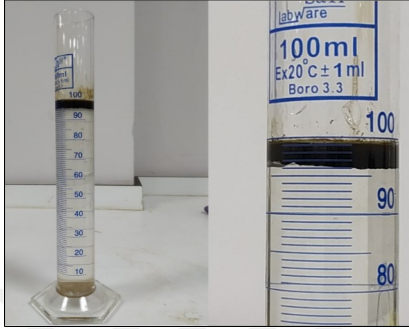
Şekil 4. 2. Ayırışma sonucu yapılan ölçüm örneği.
