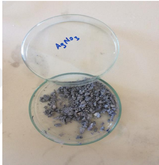
Şekil 2.4. %1'lik \text{AgNO}_3 modifikasyonlu CMC üretimi denemesi
