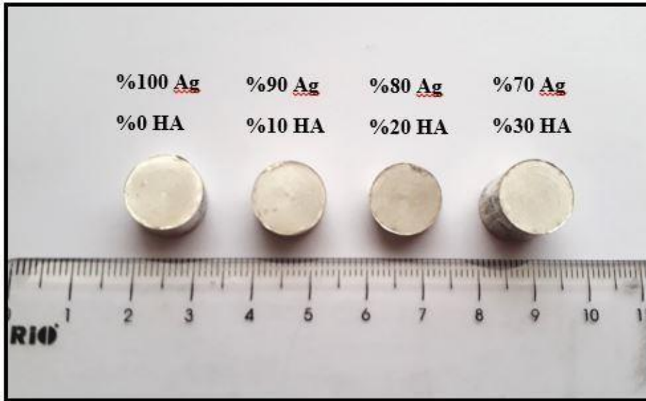
Şekil 3.23 Toz metalürjisi ile üretilen elektrotlar.
