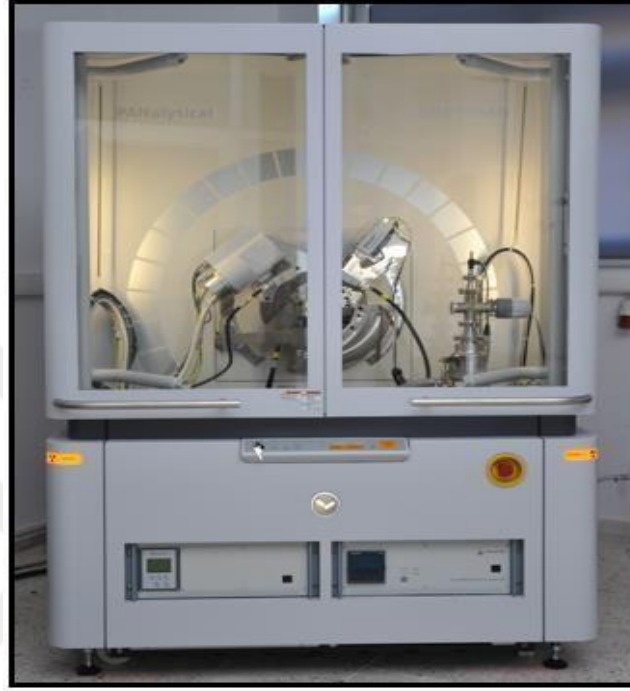
Şekil 3.14 PANALYTICAL marka, EMPYREAN model XRD cihazı.
