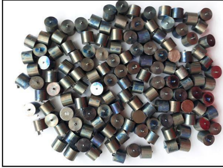
Şekil 3.15 Gerilim giderme işleminden sonra Ti-6Al-4V alaşımı.
