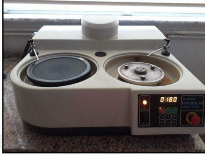
Şekil 3.7 METKON marka Forcipol-2 model zımparalama ve parlatma cihazı.
