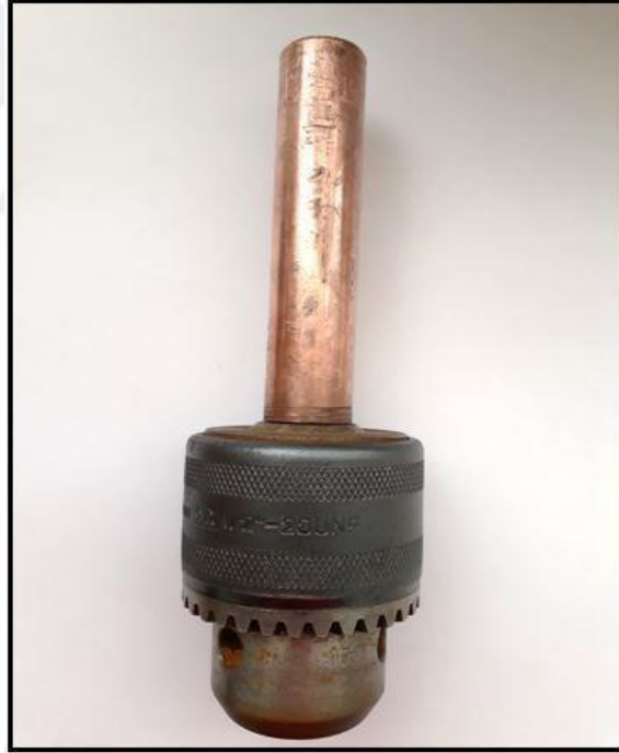
Şekil 3.25 Elektrotları tutan mandren.
