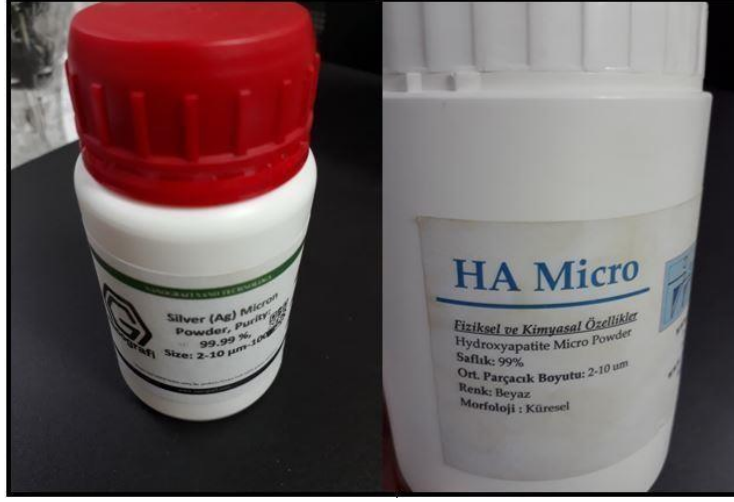
Şekil 3.17 Deneyde kullanılan mikronize gümüş ve mikronize hidroksiapatit.
