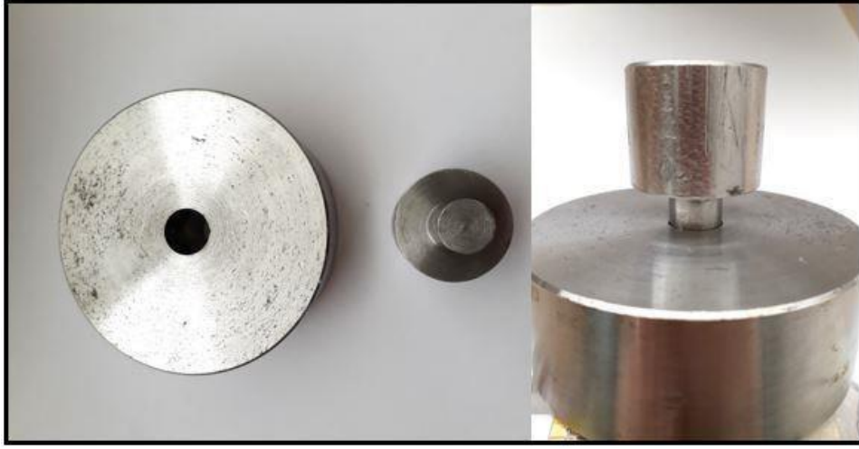
Şekil 3.22 Mikronize gümüş ve hidroksiapatit tozların sıkıştırıldığı paslanmaz çelik kalıp.
