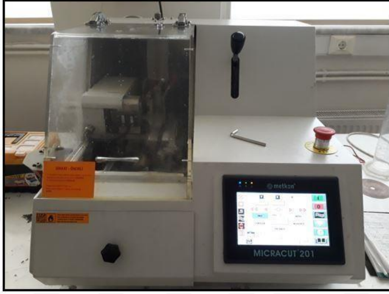
Şekil 3.10 METKON MICRACUT-201 marka yüksek hızlı hassas kesme cihazı.
