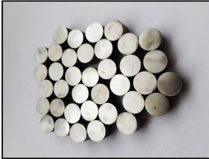
Şekil 3.16 Parlatma işleminden sonra Ti-6Al-4V alaşımı.
