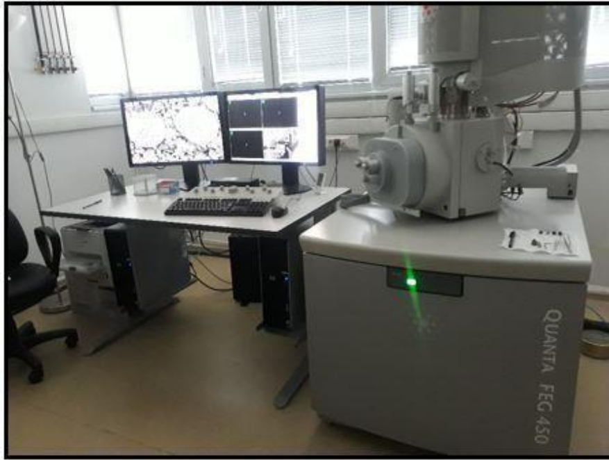
Şekil 3.9 QUANTA FEG 450 marka SEM cihazı.
