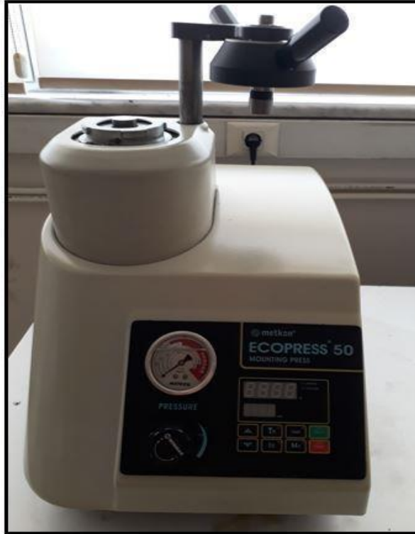
Şekil 3.11 METKON ECOPRESS-50 marka bakalit pres cihazı.
