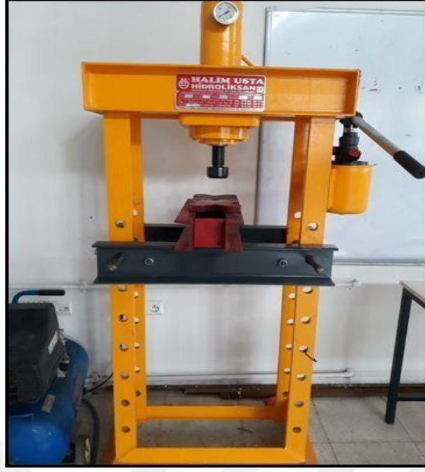
Şekil 3.4 HİDROLİK SAN atölye tipi manuel pres makinası.
