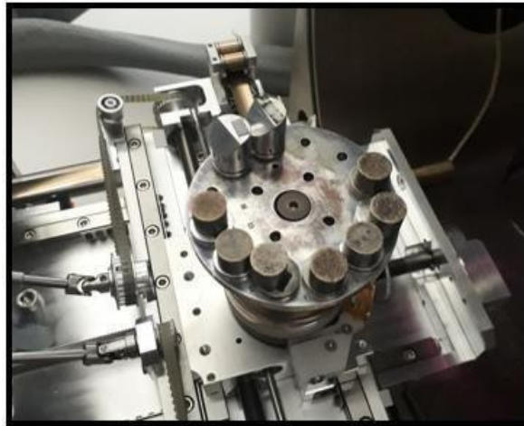
Şekil 3.31 Numunelerin SEM cihazında vakum altına alınmadan önceki görüntüsü.
