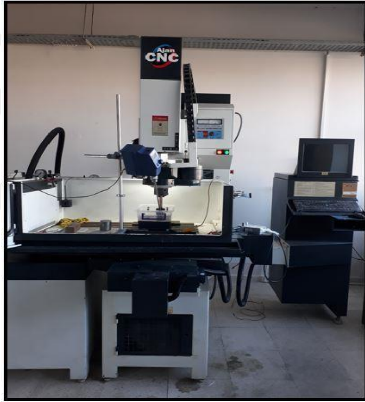
Şekil 3.3 Ajan EDM CNC Model 983 dalma tipi erozyon tezgâhı.
