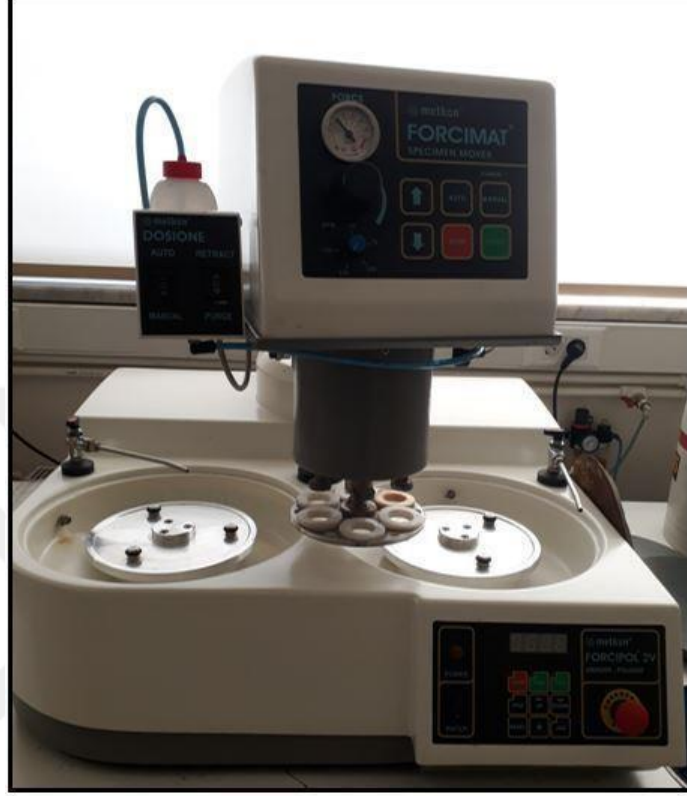
Şekil 3.12 METKON FORCIMATE marka zımparalama ve parlatma cihazı.
