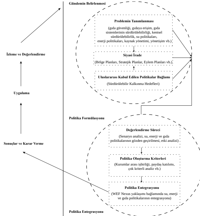
Şekil 4.3: Politika döngüsü içinde politika entegrasyonu için analitik çerçeve
