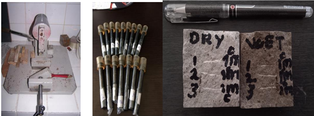
Fotoğraf 4.12. Cerchar aşındırıcılık deney aleti (sol), deneyde kullanılan uçlar (orta) ve deney sonunda kayaç yüzeyinde oluşan deney çizgi hatları (sağ)
