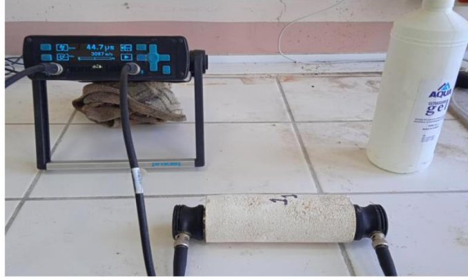
Fotoğraf 4.11. Kayaçların ultrasonik hızının Pundit Lab (+) ile belirlenmesi
