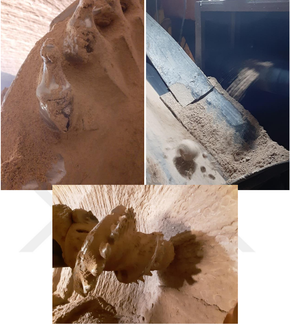
Fotoğraf 5.1. Sulu ortamda yapılan kazılar sırasında kesici uç, kesici kafa ve bant konveyöre yapışan kazılmış malzemeler
