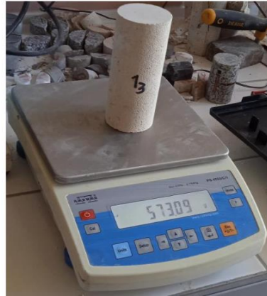
Fotoğraf 4.10. Karot numunelerin ağırlıklarının belirlenmesi
