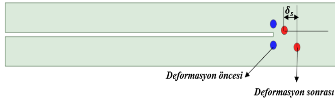
Şekil 3.12. Çatlak önü kayma deplasmanını belirlemek için kullanılan sanal noktalar
