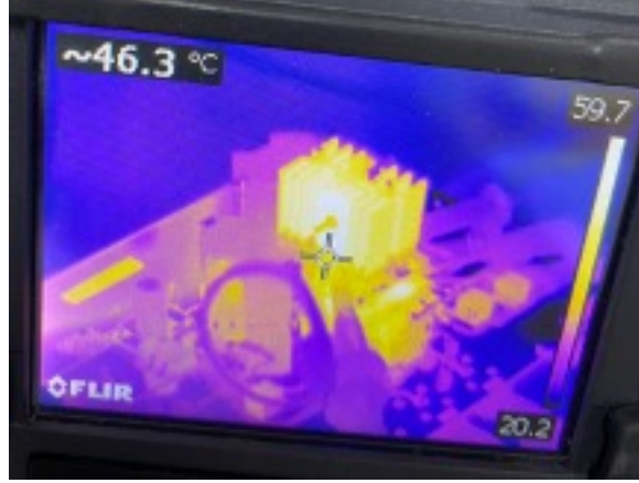
Şekil 6.7 Si MOSFET Kullanılan Dönüştürücüde 120W Çıkış Gücü Altındaki Termal Analiz
