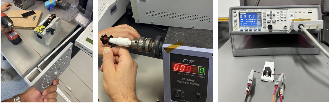
Şekil 4.6 Endüktör Sarım ve Ölçüm Aşamaları
