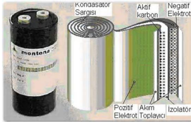
Şekil 6.5: Süperkapasitör iç yapısı [39].
