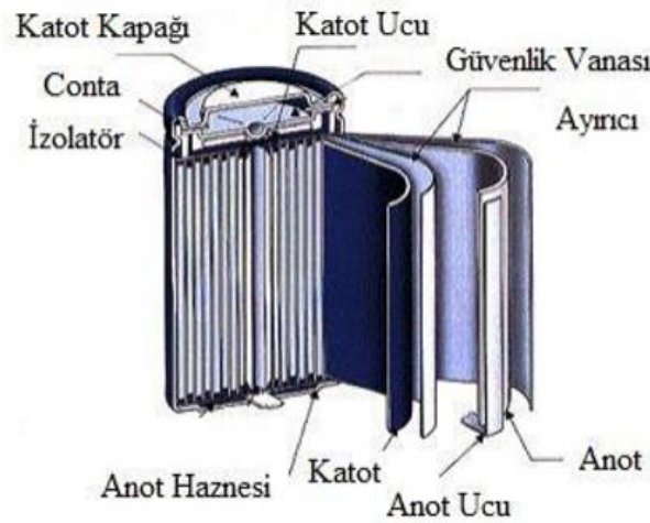
Şekil 6.4: Lityum iyon bataryanın iç yapısı [41].
