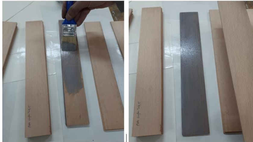
Şekil 4.4. Lamellerin tutkallanma aşaması.
