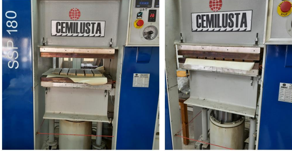
Şekil 4.5. Lamellerin preslenerek lamine ahşapların üretilmesi.
