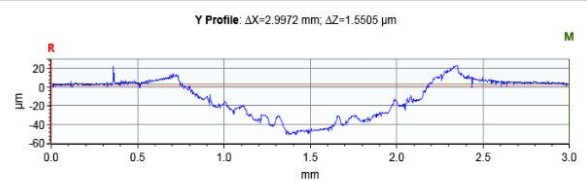
Şekil 13. MoTi kaplamalı 2,5 Hz. frekanstaki 10^4 çevrimdeki numunenin 3d profilometre görüntüsü
