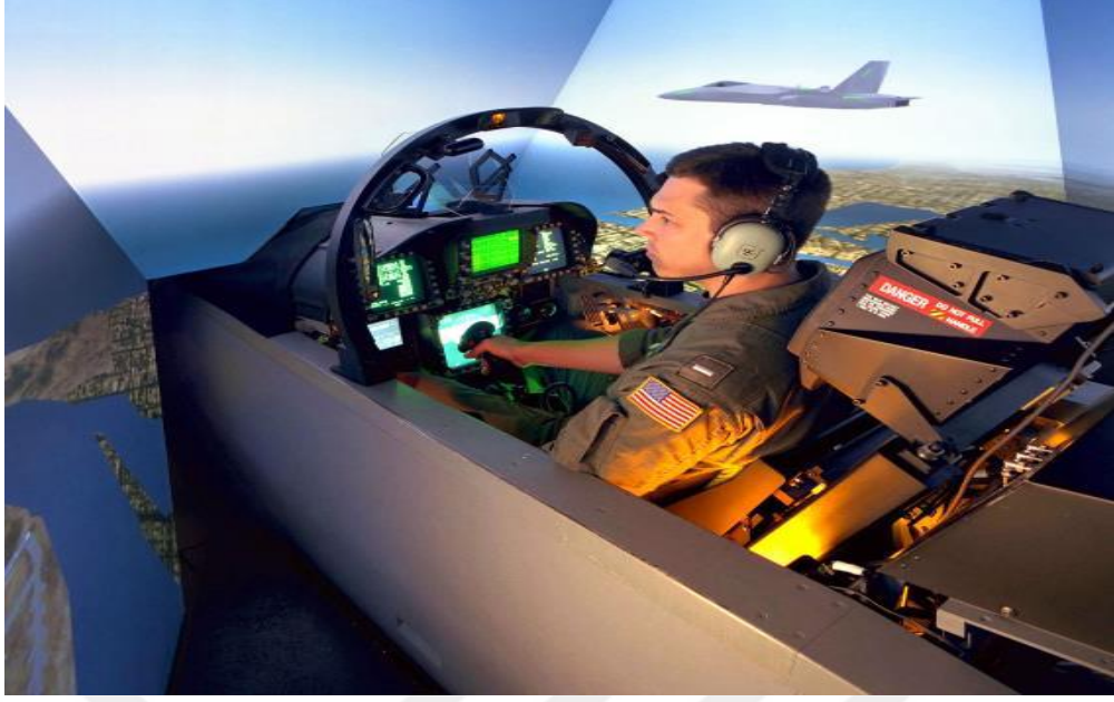
Şekil 3.7 Sanal Gerçeklik Temelli Savaş Uçağı Simülatörü
