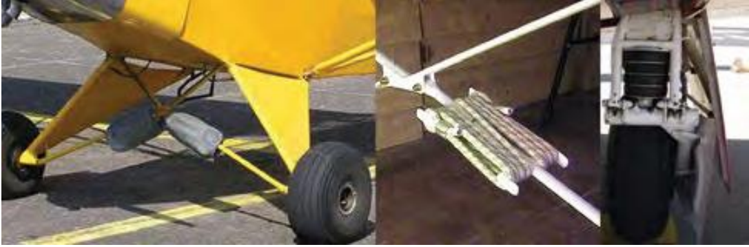
Şekil 3.4. Bungee Cordon Şok Sönümleyici [80].
