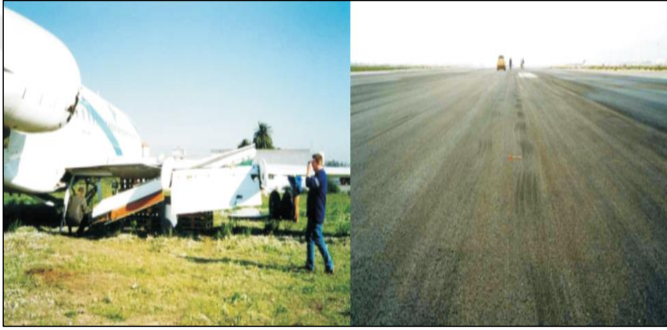
Şekil 1.3. Shimmy Kaza Görseli FOKKER MK-100 [12].
