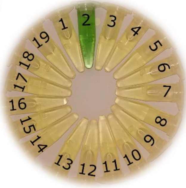
Şekil 4.23 : 3,0 \times 10^{-5} M CSME sensörünün asetonitril: HEPES tampon çözeltisi (5:1, v/v, pH 7,4) ortamında farklı metal katyonları (5 ekivalent) varlığındaki a) 711 nm'deki absorpsiyon değerleri b) 740 nm'deki floresan şiddeti değişimleri c) metal tuzları ( \text{Hg}^{2+} (2), \text{Li}^+ (3), \text{Na}^+ (4), \text{K}^+ (5), \text{Cs}^+ (6), \text{Mg}^{2+} (7), \text{Ca}^{2+} (8), \text{Sr}^{2+} (9), \text{Ba}^{2+} (10), \text{Mn}^{2+} (11), \text{Fe}^{2+} (12), \text{Fe}^{3+} (13), \text{Co}^{2+} (14), \text{Ni}^{2+} (15), \text{Cu}^{2+} (16), \text{Zn}^{2+} (17), \text{Cd}^{2+} (18) ve \text{Pb}^{2+} (19)) varlığında CSME(1) çözeltisinin görsel davranışı.
