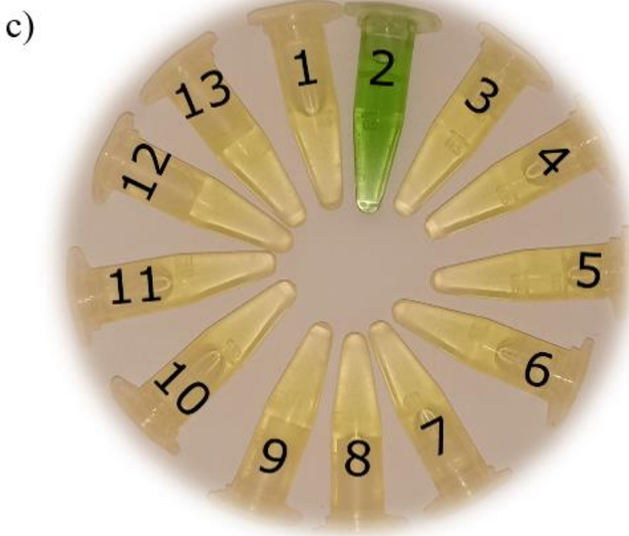
Şekil 4.24 : 3,0 \times 10^{-5} M CSME sensörünün asetonitril: HEPES tampon çözeltisi (5:1, v/v, pH 7,4) ortamında farklı anyonlar (5 ekivalent) varlığındaki a) 711 nm'deki absorpsiyon değerleri b) 740 nm'deki floresan şiddeti değişimleri c) Hg 2+ (2) ve anyonlar (SO 4 2- (3), CN - (4), CO 3 2- (5), S 2- (6), Cl - (7), NO 3 - (8), Br - (9), SCN - (10), EDTA 2- (11), AcO - (12) ve I - (13)) varlığında CSME(1) çözeltisinin görsel davranışı.
