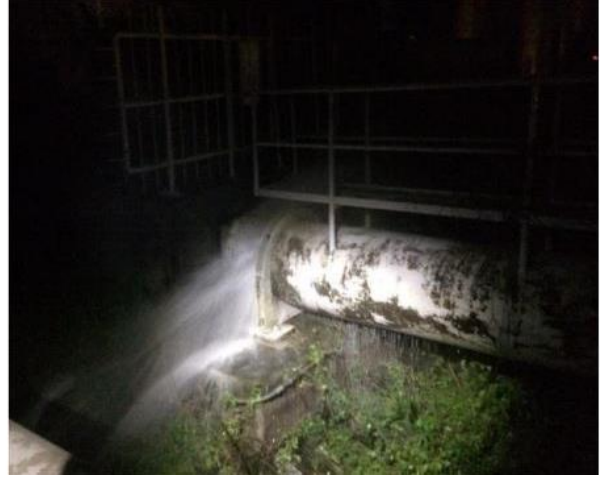
Şekil 3.5 2016 Kumamoto depremi sonrasında içme suyu hattında meydana gelen hasar (Wham vd., 2017)
