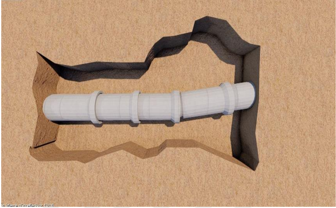
Şekil 5.5 552-552/A boru hattı hafif hasar örneği temsili 3 boyutlu üstten görünüş
