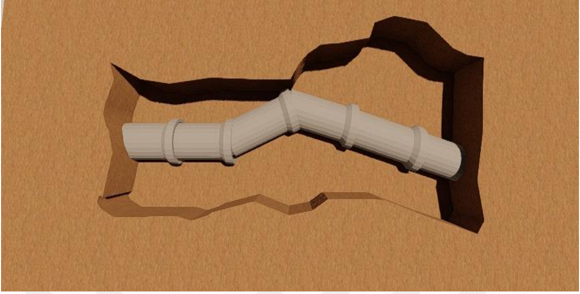
Şekil 5.21 1115-1116 boru hattı ağır hasar örneği temsili 3 boyutlu üstten görünüş
