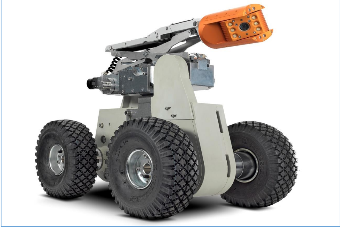
Şekil 5.2 Kamera monte edilmiş CCVT’li görüntüleme aracı
